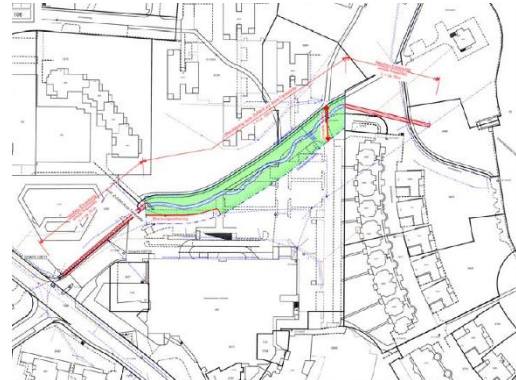
Abbildung 39: Empfohlene Variante Bachverlegung
