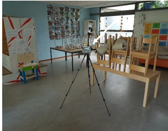
Abb. 27: Betr. EG, Raumluftmessung auf flüchtige org. Verb.
