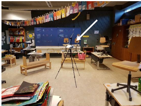
Abb. 3: Pavillon 2, Raum P2/23, Raumluftmessung auf flüchtige org. Verb.
