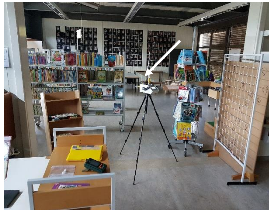
Abb. 23: Pavillon 1, Raum P1/13&11, Raumluftmessung auf flüchtige org. Verb.
