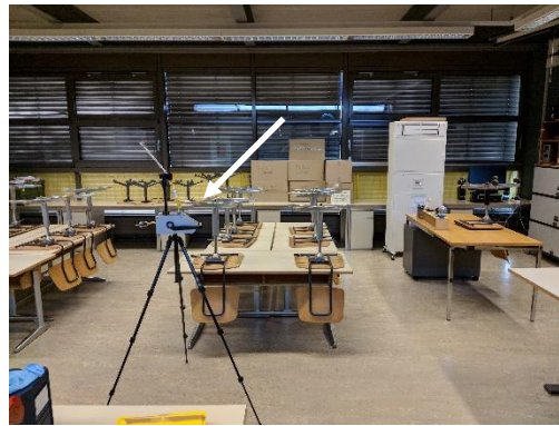
Abb. 8: Pavillon 1, Raum 18, Raumlufthmessung auf flüchtige org. Verb.
