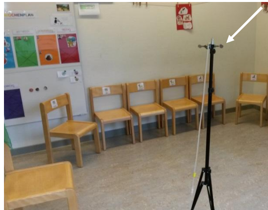
Abb. 4: Pavillion 2, Raum P2/KiGa II, Raumluftmessung auf flüchtige org. Verb.
