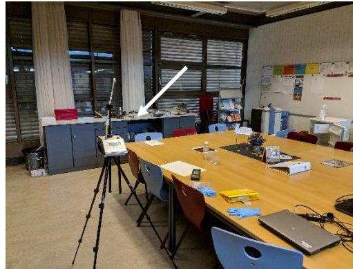
Abb. 6: Pavillon 2, Raum 21, Raumlufthmessung auf flüchtige org. Verb.
