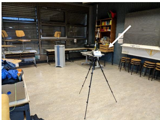
Abb. 9: Pavillon 1, Raum 17, Raumlufthmessung auf flüchtige org. Verb.
