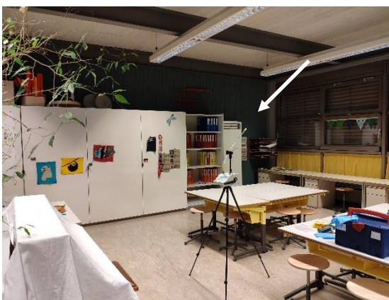
Abb. 5: Pavillon 1, Raum 17, Raumlufmessung auf flüchtige org. Verb.
