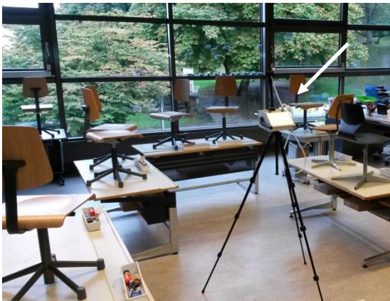
Abb. 3: Pavillion 2, Raum P2/23, Raumluftmessung auf flüchtige org. Verb.
