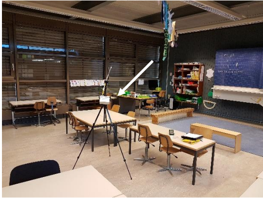
Abb. 14: Pavillon 2, Raum P2/24, Raumluftmessung auf flüchtige org. Verb.
