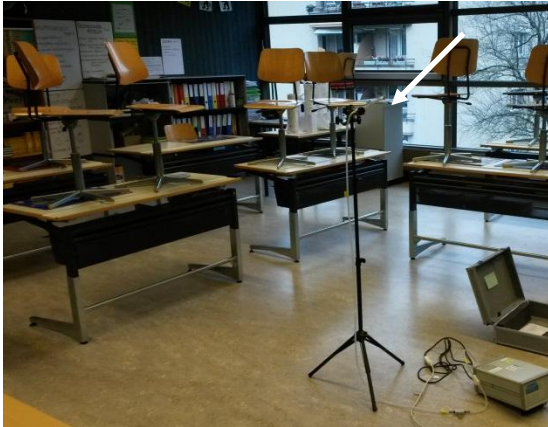
Abb. 1: Pavillion 1, Raum P1/15, Raumluftmessung auf flüchtige org. Verb.
