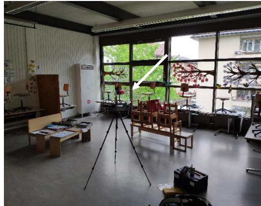
Abb. 2: Pavillon 1, Raum 11, Raumlufmessung auf flüchtige org. Verb.
