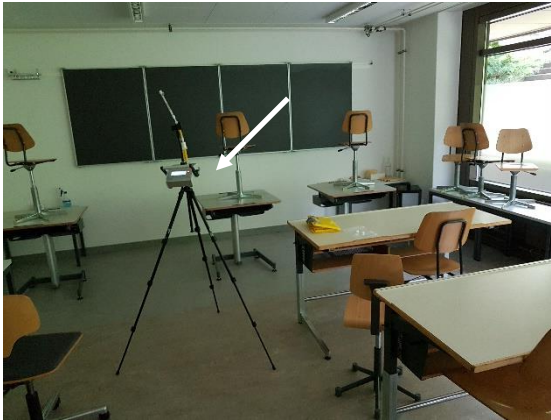
Abb. 26: Pavillon 1, Raum P1/1D, Raumluftmessung auf flüchtige org. Verb.
