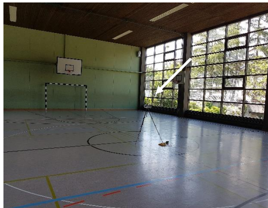
Abb. 29: Turnhalle, Raumluftmessung auf flüchtige org. Verb.
