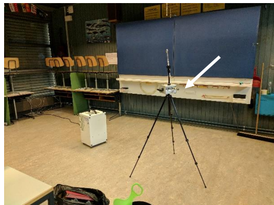
Abb. 10: Pavillon 1, Raum 15, Raumlufthmessung auf flüchtige org. Verb.
