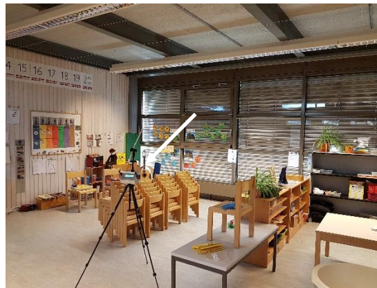
Abb. 17: Pavillon 2, Raum P2/KiGa I, Raumluftmessung auf flüchtige org. Verb.
