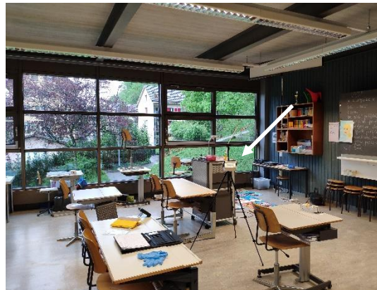
Abb. 4: Pavillon 1, Raum 17, Raumlufmessung auf flüchtige org. Verb.
