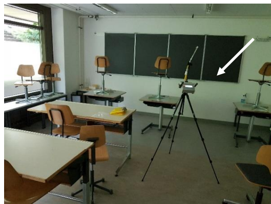
Abb. 25: Pavillon 1, Raum P1/1E, Raumluftmessung auf flüchtige org. Verb.
